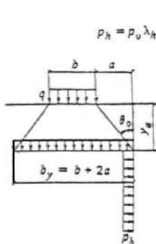
Черт. 2. Схема распределения давления от полосовой нагрузки
