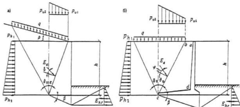
Черт. 1. Расчетные схемы подпорных стен
